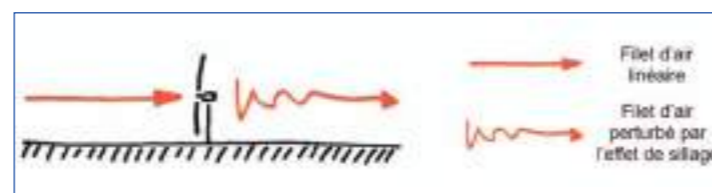
Figure 359 : Principe de l'effet de sillage
