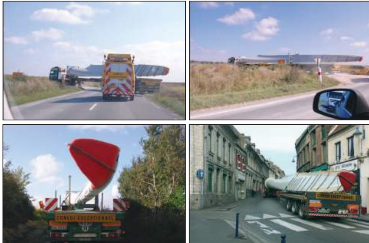
Figure 42 : Solutions de transport des pales d'éoliennes
