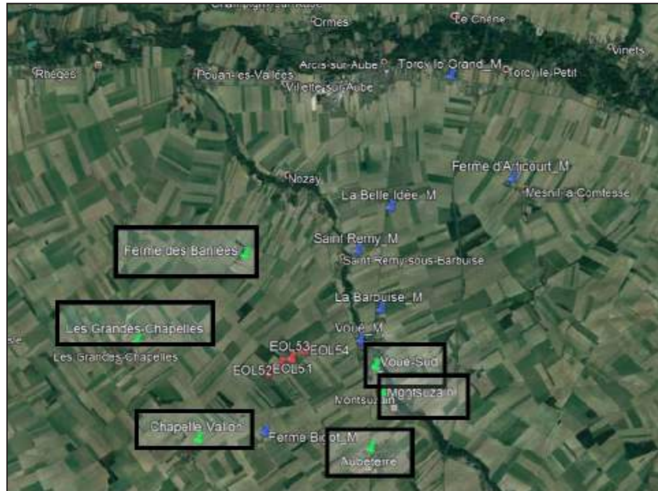
Figure 621 : Récepteurs des calculs, modélisation du site avec futures éoliennes du projet : points complémentaires (en bleu et encadrés) et points de mesures (en rouge), extrait de l'étude d'impact acoustique, ECHOPSY, 2020
